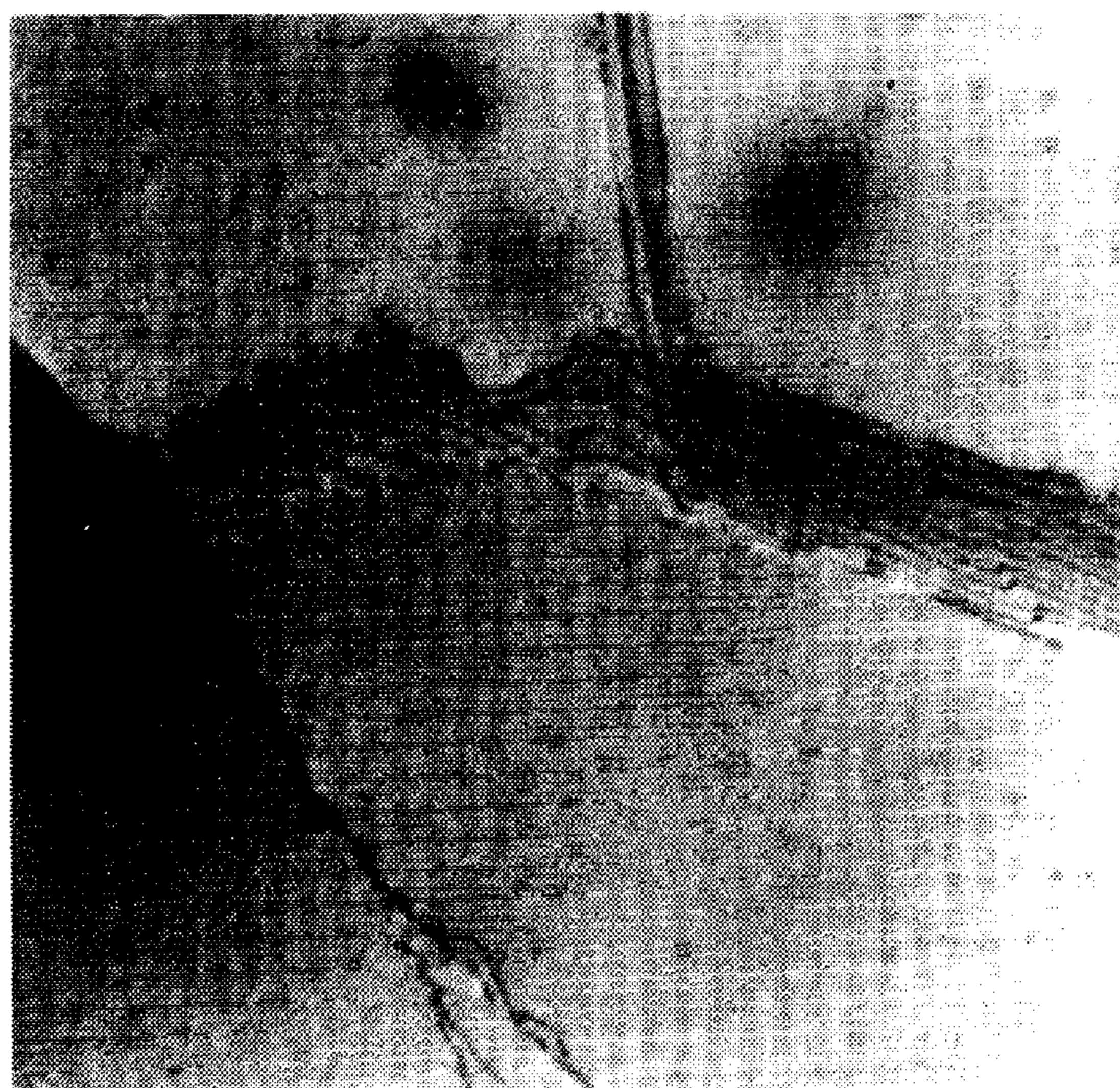
图 12 Al-7%Mg 固溶体合金中低角晶界位错结构的电子显微镜照片。注意图右方连成一条条线的那些小点。放大： \times 17000 。引自 R. Goodrich and G. Thomas。
